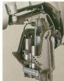
また、ショックアブソーバ機能も備え、航走中、異物に当たっても、ショックを吸収し、内部のフリーピストンの作動で、元のトリム位置に自動復帰します。(EPTO)
